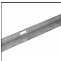
Hoeklijn, 20 x 20 x 3 mm, met slobgat h.o.h. 600 mm, gegalvaniseerd
